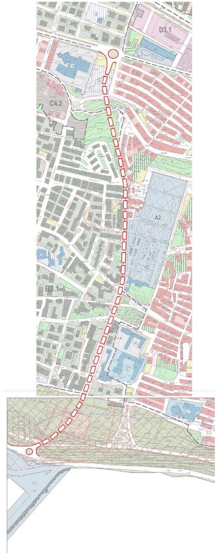
*Proposta di tracciato della strada di collegamento fra il porto e la nuova strada sull'asse ferrato*
