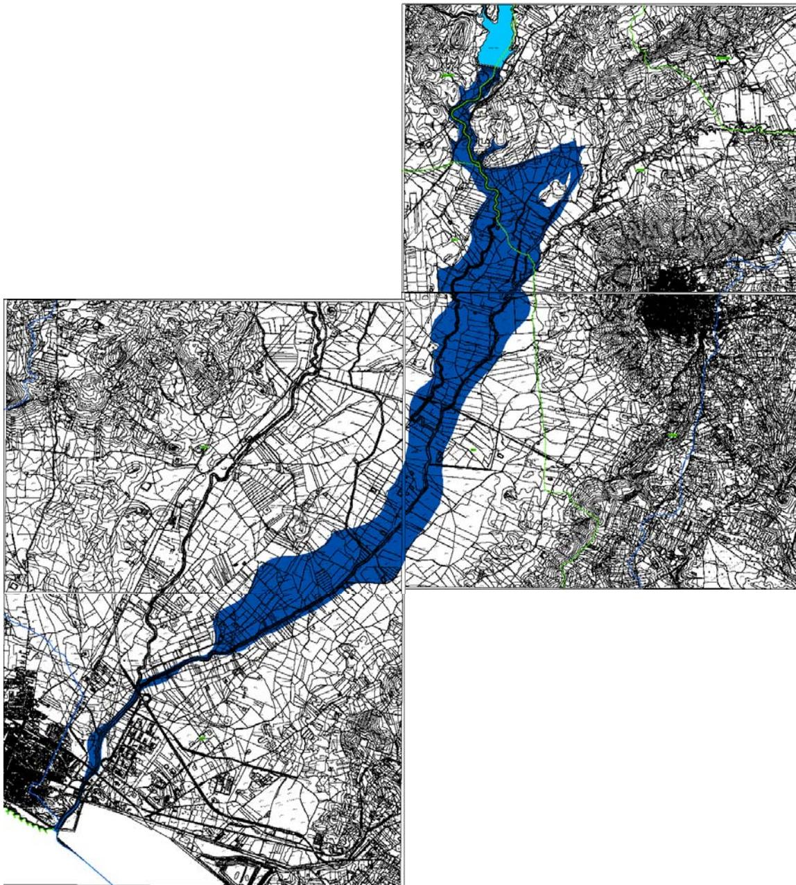
Fig. A.3.3.2.10 Carta delle aree di esondazione per l'ipotetico collasso dello sbarramento della Diga Cimìa
